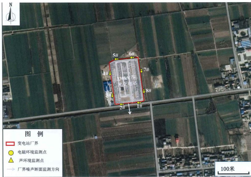
图 2 春光 330kV 变电站厂界检测点位示意图
